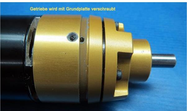
Um das Getriebe zu öffnen wird lediglich eine Senkkopfschraube entfernt und dann der Getriebevorsatz abgeschraubt. (nachfetten)
